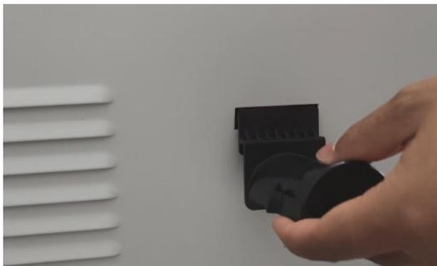
6-3. Cuelgue el filamento en el soporte y corte el extremo del filamento en un ángulo de 45 grados con alicates diagonales.
