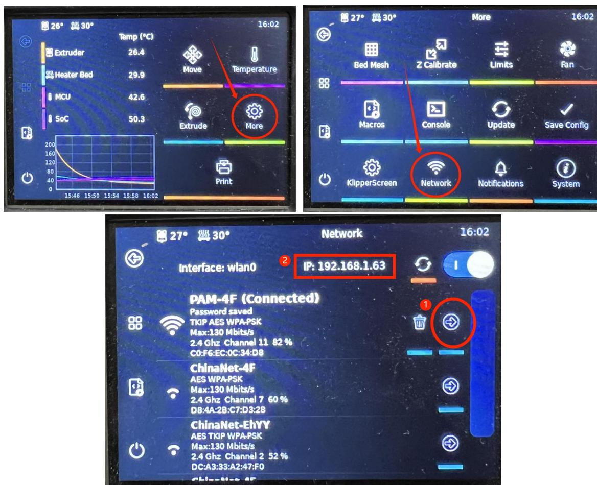
② Regrese a la interfaz del software de corte, haga clic en el icono "WIFI", modifique el nombre, introduzca la dirección IP mostrada en la pantalla anterior, haga clic en "Test", si muestra que se conecta correctamente a OctoPrint, significa que la entrada es correcta, haga clic en "OK", y confirme nuevamente para completar el emparejamiento entre el software de corte y el IT3D H300.
