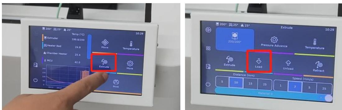
**Nota: Si la extrusión es exitosa, por favor conecte el tubo blanco en la parte superior del cabezal del extrusor firmemente.**
