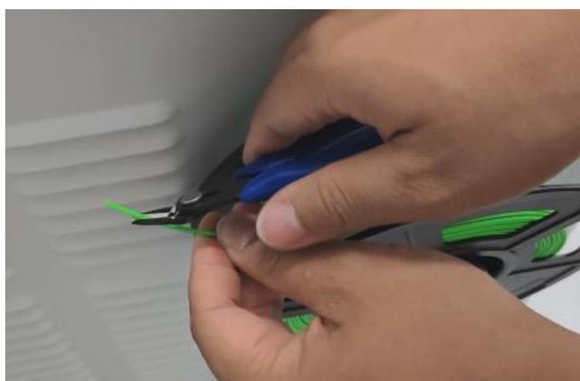
6-4. Empuje el filamento en el sensor de detección de rotura de material, retire el tubo blanco de la parte superior del extrusor, extraiga el filamento e insértelo en el pequeño orificio en la parte superior del extrusor, luego vuelva a insertar el tubo blanco.
